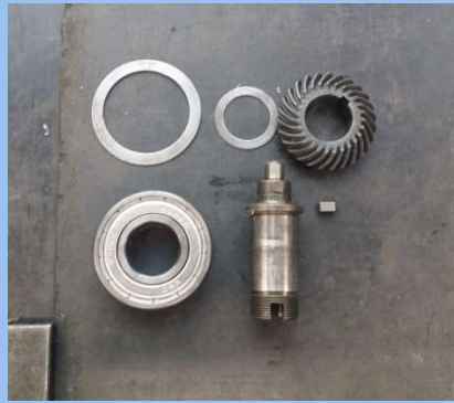
19) SPINDLE ASS' Y 분해모습
