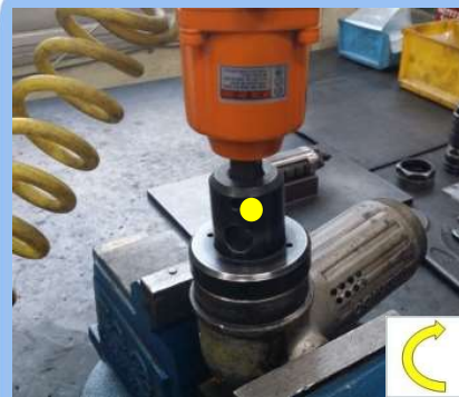
11) BEARING COVER 분해 (IMPACT WRENCH 사용)
