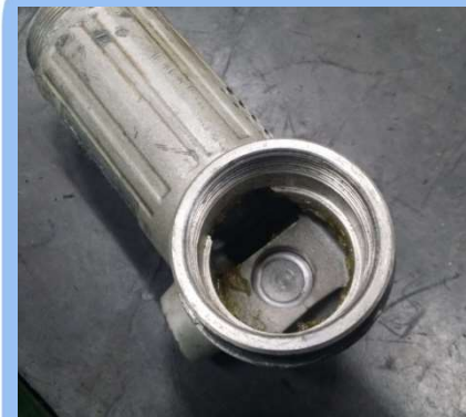
39) CASING에 BEARING WASHER 조립
