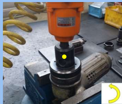
46) BEARING COVER 조립 (IMPACT WRENCH 사용)
