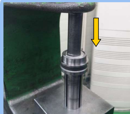
29) FRONT와 BEARING(6301ZZ)를 조립
