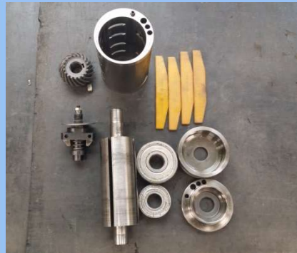
25) MOTOR ASS' Y 분해 모습
