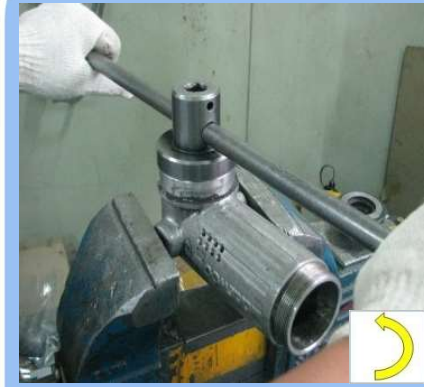
45) BEARING COVER 조립 (핸들 바사용)
