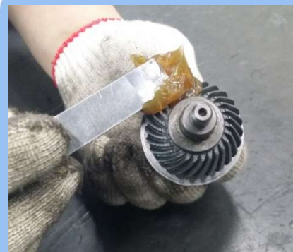
41) DRIVEN GEAR에 구리스 도포
