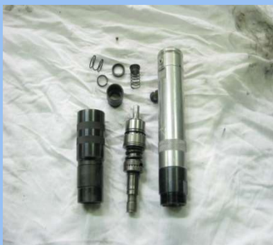
5)CLUTCH HOUSING 분해 모습
