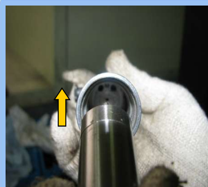
16)MOTOR HOUSING에 ROTOR ASSY 조립
