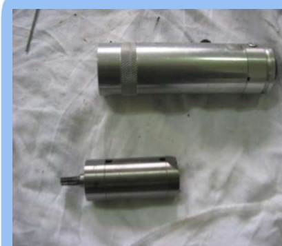
9) MOTOR HOUSING과 MOTOR ASSY 분해 모습
