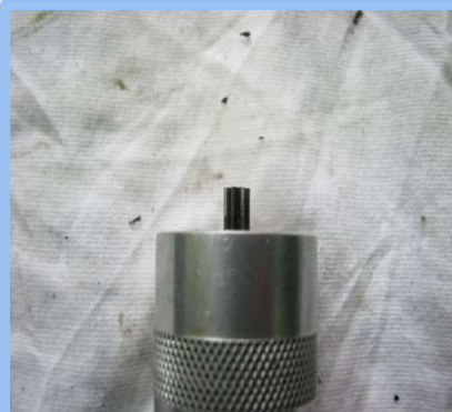
17) MOTOR HOUSING에 ROTOR ASSY 조립 후 확인
