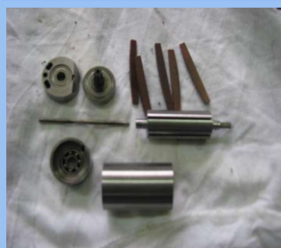
11) MOTOR ASSY 분해 모습
