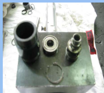
22) GEAR CAGE 분해 모습
