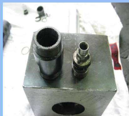
19) GEAR CAGE 분해 모습
