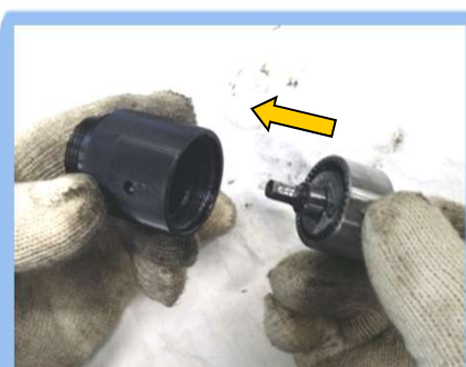
41) GEAR CASING과 GEAR CAGE 조립
