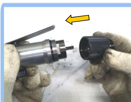
42) CASING에 GEAR CASING ASSY 조립
