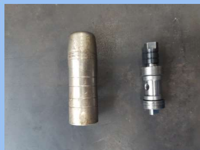
8) COLLET CHUCK CASING과 SHAFT 분해 모습
