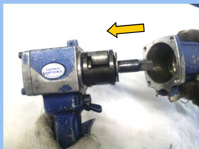
43) HAMMER CASING 조립
