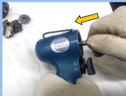
20)HOUSING MOTOR에 ROTOR ASSY 조립
