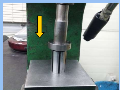
16) ROTOR와 REAR PLATE 조립
