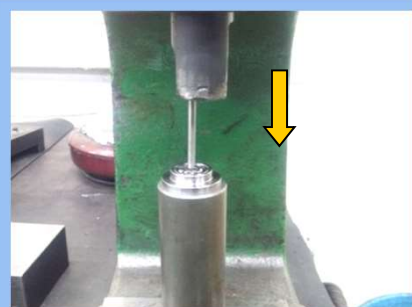
10)ROTOR와 REAR PLATE 분해
