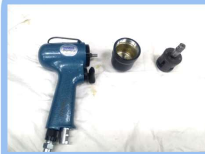
3)HAMMER CASING 분해 모습
