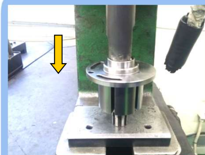
21)ROTOR와 REAR PLATE 조립
