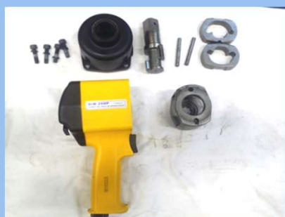
8)CAGE HAMMER ASSY 분해 모습
