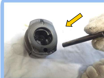
30)HAMMER PIN 조립
