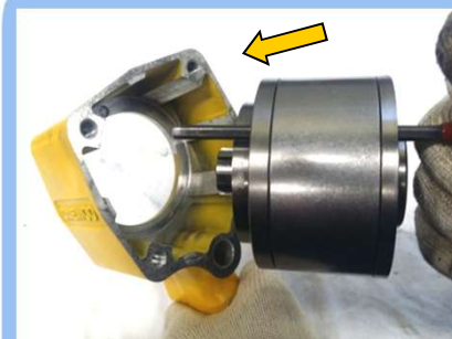
27)HOUSING에 ROTOR ASSY 조립
