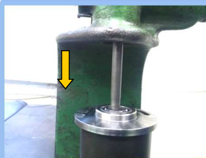
17)ROTOR와 REAR PLATE 분해
