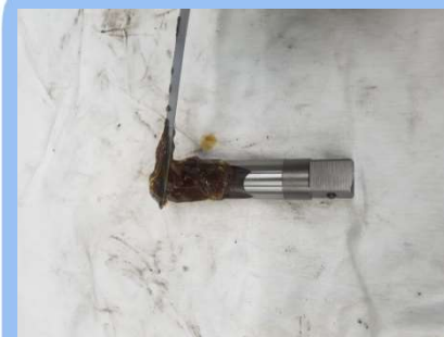
36) ANVIL GREASE 도포
