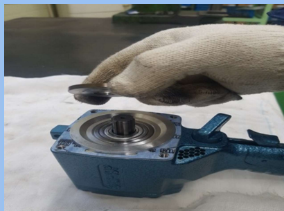
32) HAMMER CASING SPACER 조립
