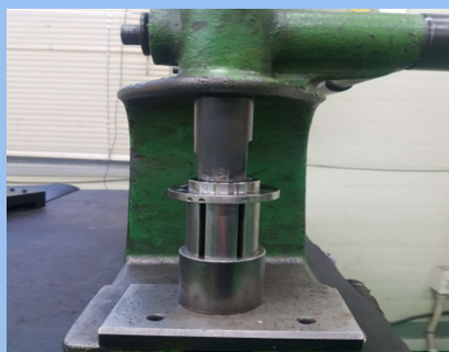
23) ROTOR 와 REAR PLATE 조립
