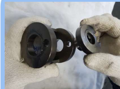
33) CAM HAMMER 조립
