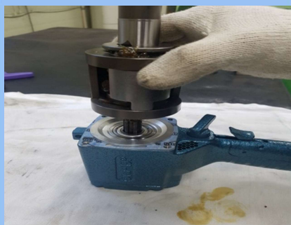
40) CAGE HAMMER ASSY 조립
