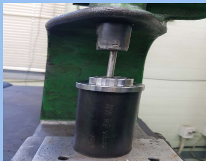
20) ROTOR 와 REAR PLATE 분해
