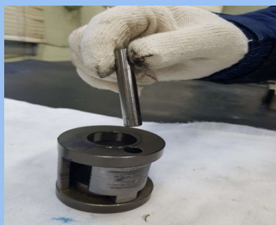
35) HAMMER PIN 조립
