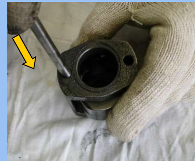
21)HAMMER PIN 조립
