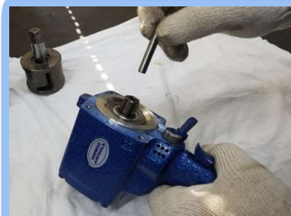
30) CENTER ROD 조립
