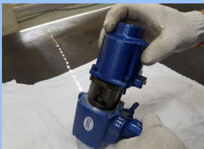
37) HAMMER CASING 조립
