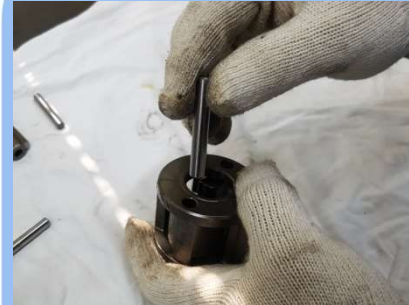
33) HAMMER PIN 조립
