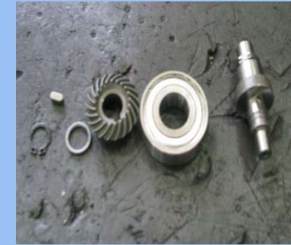
21) SPINDLE DODULE 분해 모습
