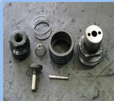
23) HANLDE BODY MODULE 분 해 모습
