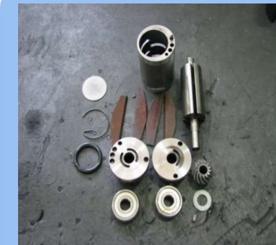
17) MOTOR MODULE 전체 분해 모습
