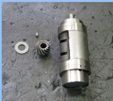
10) DRIVNIG GEAR 분해 모습
