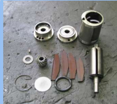
14) MOTOR MODULE 분해 모습
