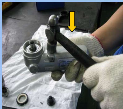
25)CASING에서 SPINDLE ASSY 분해
