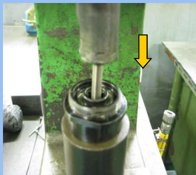
11)GUIDE SHAFT에서 TOOL HOLD 분해
