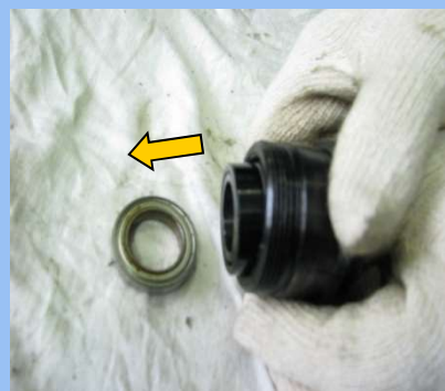
13)GUIDE SHAFT의 BEARING 분해
