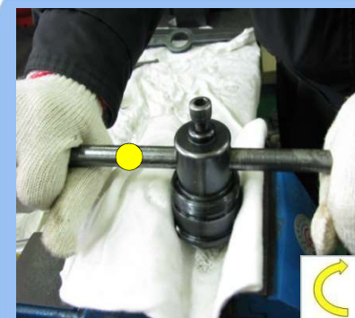
12)GUIDE SHAFT의 JOINT 분해
