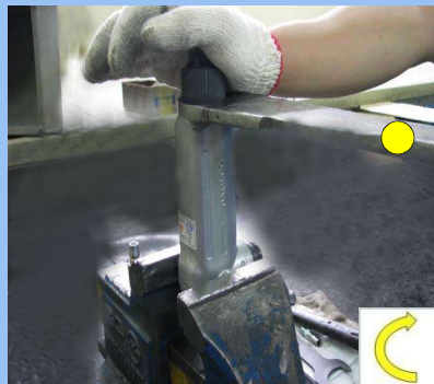
38)CASING에 HANDLE BODY ASSY 조립
