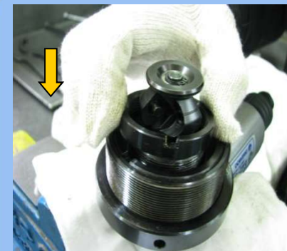
39)INNER JOINT 조립-1 (나사고정제 도포 후)
