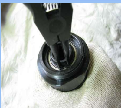
10)GUIDE SHAFT의 SNAP RING 분해
